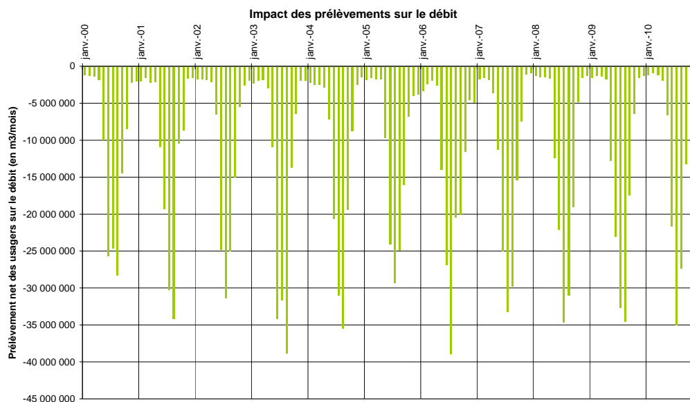
Figure 5-29: Volume mensuel de prélèvement net des usagers de l'eau sur le débit à l'exutoire - Sous-bassin versant Arve Aval et affluents rive Gauche
