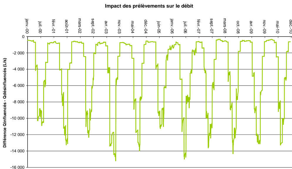
Figure 5-28- Différence entre les débits simulés non désinfluencés et simulés désinfluencés - Sous-bassin versant Arve Aval et affluents rive Gauche
